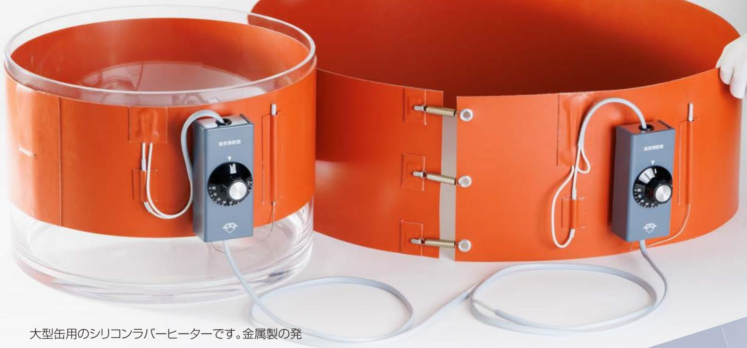
大型缶用のシリコンラバーヒーターです。金属製の発熱体をガラス繊維が入ったシリコンゴムシートで挟み込んで成形。温度ヒューズ・温度調整器もセット納品できます。シートはスプリング・マジックテープ等により着脱可能。ご利用サイズにも幅を持たせられます。1枚からオーダーメイドで製作可能です。
